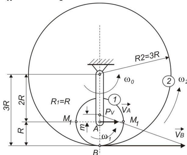
Kako se zupčanik 2 okreće sa  $\omega_1$  brzina tačke B zupčanika 2 je
