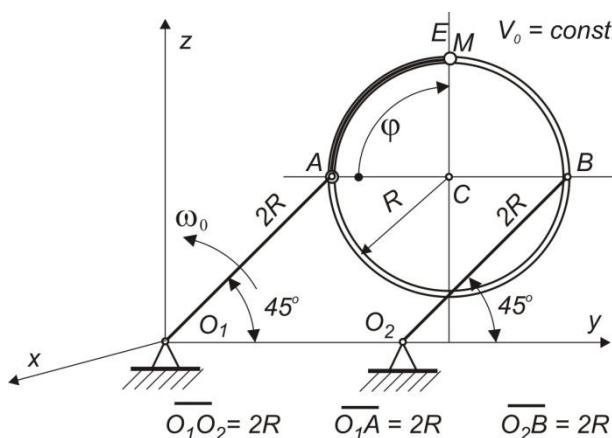
Cev se kreće posredstvom poluga  $O_1A=2R$  i  $O_2B=2R$ , koje se obrću oko nepomičnih osa  $O_1$  i  $O_2$ . Poluga  $O_1A$  se obrće ugaonom brzinom konstantnog intenziteta  $\omega_{OA} = \omega_0 = \text{const.}$  U trenutku kada poluga  $O_1A$  gradi ugao od  $45^\circ$  u odnosu na horizontalu  $O_1O_2$  tačka M je u najvišoj tački E. Odrediti apsolutnu brzinu i ubrzanje tačke M u tom trenutku.
