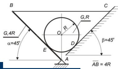
Homogeni prav štap AB dužine  $4L$  i težine G je vezan zglobom A za postolje, a krajem B vezan je horizontalnjem užetom. Na štapu se nalazi homogeni disk poluprečnika i težine G, čiji je centar O vertikalno iznad zgloba A. Štap sa horizontalom zaklapa ugao od  $\alpha=45^\circ$ .
