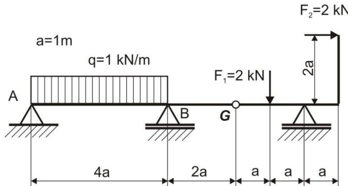
Da bi se rešila data greda treba paralelno premestiti silu  $F_2$  na pravac grede što uslovjava dodavanje momenta u tački u koju se sila premešta a jednakog proizvodu normalnog rastojanja i sile. U osloncima se zamenjuje njihovo dejstvo reakcijama oslonaca, kod tačke nepokretnog oslonca A kosa sila u ravni odnosno dve komponente i u tački pokretnog oslonca B vertikalna sila.
