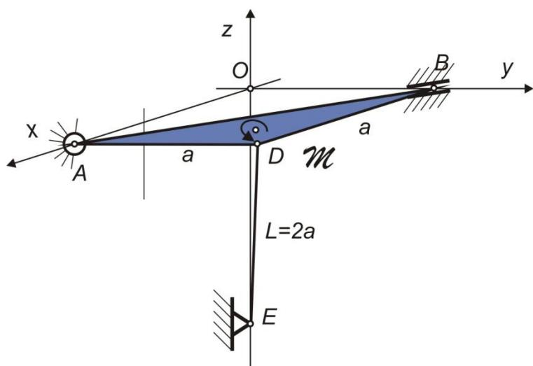
Rešavanje počinje oslobođanjem veza, ali treba uočiti da je osa oslonca B u pravcu hipotenuze trougaone ploče, pa je normalan na nju. Komponenta u horizontalnoj ravni može se razložiti na dve, a pošto horizontalna reakcija  $F_B$  sa osama zaklapa isti ugao to su i projekcije iste.
