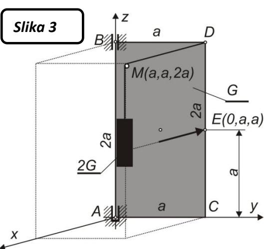
Pravougaona ploča ABCD težine G, stranica a i  $2a$ , leži u vertikalnoj ravni. Vezana je sfernim zglobom A i cilindričnim zglobom B. U tački D je vezano uže DM i prebačeno preko kotura M zanemarljivih dimenzija. O uže je okačen teret težine  $2G$ . U tački E na sredini desne ivice ploče deluje horizontalna sila F normalna na ploču.  $\vec{F} = -F \vec{i}$
