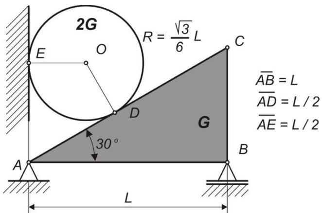
Homogena ploča ABC oblika pravouglog trougla, težine G, čija je strana AB=L, se oslanja na nepokretni oslonac A i pokretan oslonac B. Homogeni disk težine 2G i poluprečnika  $R = \frac{\sqrt{3}}{6}L$  oslanja se na stranu AC homogene ploče i na glatki vertikalni zid.
