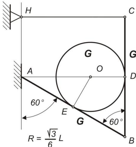
Sistem krutih tela sastoji se od konzole AB dužine L i težine G, grede BC dužine L i težine G, nerastegljivog užeta CH i homogenog diska O, prečnika R i težine G. Disk se oslanja u tačkama E i D koje su sredine greda AB i BC. Greda BC je vertikalna dok konzola AB zaklapa ugao od  $60^\circ$ , uže CH je horizontalno. Konzola i greda su zglobno vezane u tački B a u tački A konzola je uklještena.
