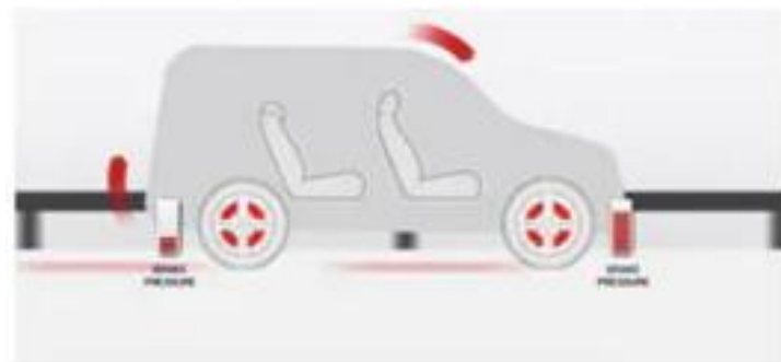
Возило са системом електронске расподеле кочних сила
