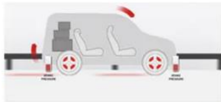
Возило са системом електронске расподеле кочних сила
